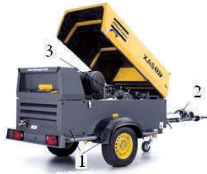
Сл.10 . Компресорска станица во метален орман и на возило:1- возило; 2- алка за влечење; 3- дизел компресор.
