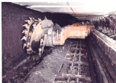
Сл.43. Копање на јаглен со струг во откоп со широко чело.
