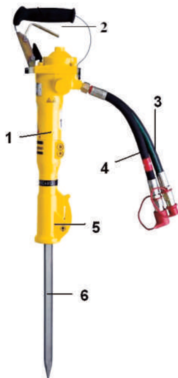
Сл.30. Хидрауличен откопен чекан; 1-цилиндар, 2-рачка за држење, 3-црево за довод на масло, 4-црево за одвод на масло, 5-држач на длетото, 6-откопно длето.
