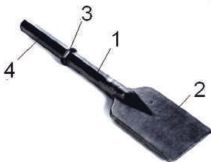
Сл.28. Откопна лопата: 1-шипка; 2-сечиво; 3-границник; 4-всадник.
