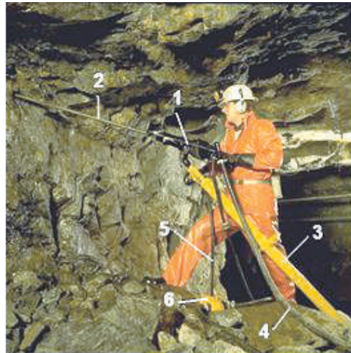
Сл.50. Дупчење со рачен дупчачки чекан: 1-дупчачки чекан; 2-длето; 3-потпорна ногара; 4-цевро за воздух; 5-цевро за вода; 6-мазналка.
