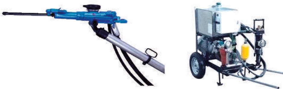
Сл.62. Рачен хидрауличен дупчачки чекан и агрегат за производство на хидраулична енергија
