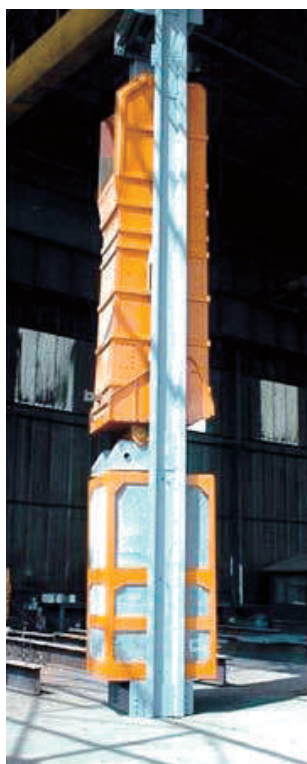
Сл.151. Комбиниран извозен сад: 1-окно; 2-водилки; 3-скип; 4-кош; 5-довозиште; 6-бункер; 7-додавач; 8-дозатор; 9-пресдуктор; 10-цилиндр.
