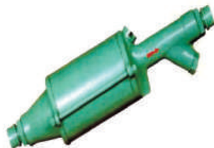
Сл.49. Автоматска подмачкувалка:1-резервоар за масло; 2-отвор за полнење; 3-отвори за приклучување на цревето за компримиран воздух.
