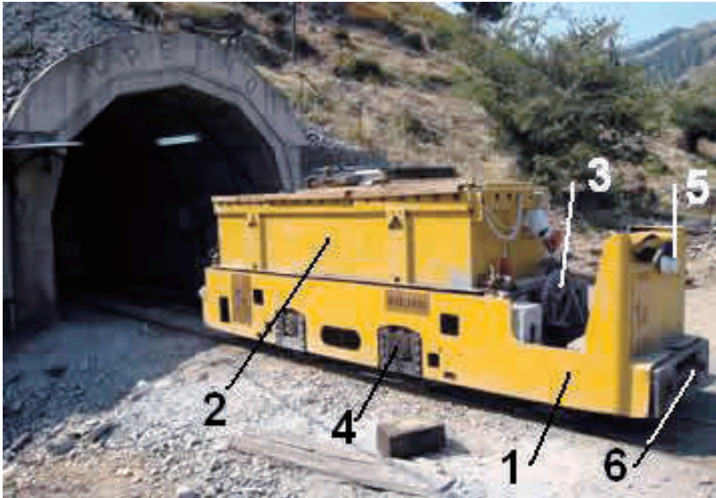
Сл.124. Акумулаторска локомотива : 1-шасија; 2-акумулатори; 3-кабина за ракувачот; 4-амортизери; 5- светло; 6- место за закачување на вагон.
