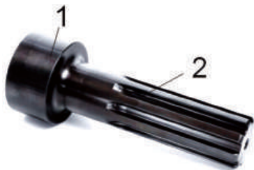
Сл.47. Клип со клипњача:1-клип; 2- клипњача.
