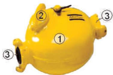
Сл.49. Автоматска подмачкувалка:1-резервоар за масло; 2-отвор за полнење; 3-отвори за приклучување на цревето за компримиран воздух.
