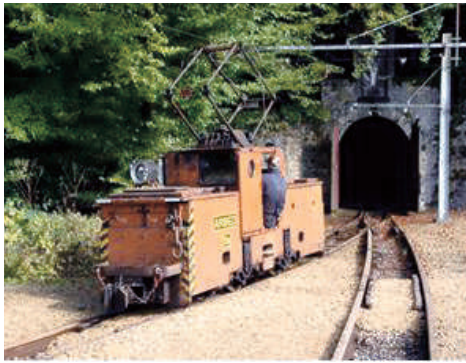
Сл.121. Контактна локомотива:1-шасија; 2-кабина; 3-трола; 4-место за закачување на вагоните.
