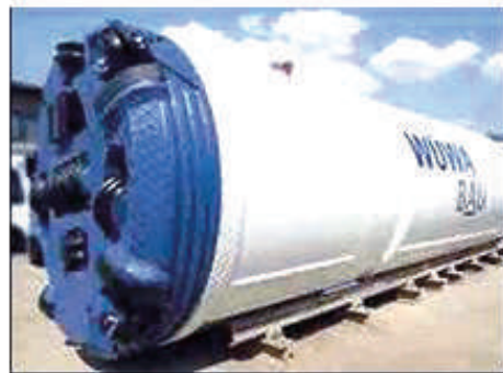
Сл.33. Ротациска пробојна машина со трокрак назабен ротор: 1-ротор, 2-труп на машината, 3- гасеници.
