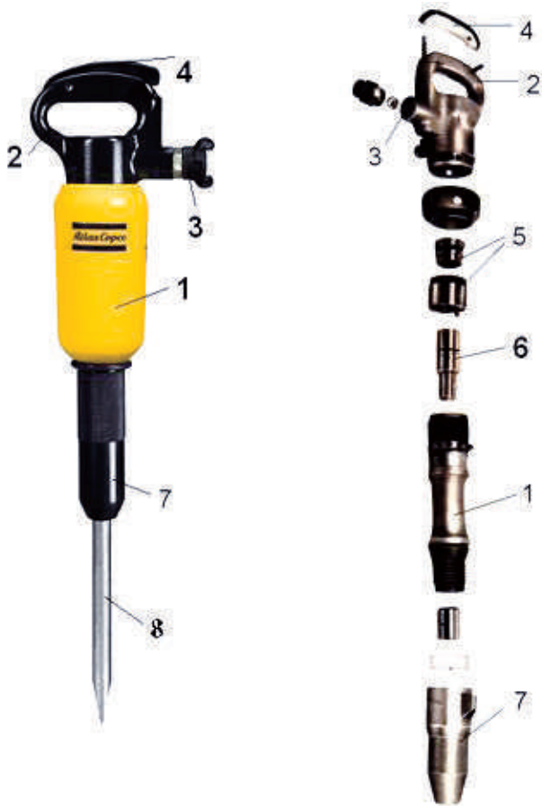
Сл.26. Пневматски откопен чекан: 1-цилиндр; 2-рачка за држење; 3-приклучок за компримиран воздух; 4-пуштач; 5- разводник; 6-клип; 7-држач на откопно длето; 8- откопно длето.
