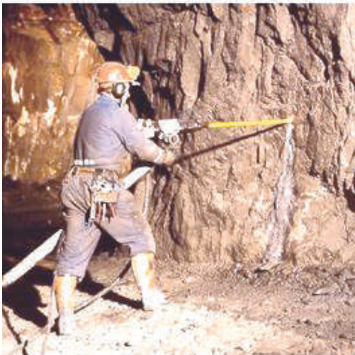
Сл.50. Дупчење со рачен дупчачки чекан: 1-дупчачки чекан; 2-длето; 3-потпорна ногара; 4-цевро за воздух; 5-цевро за вода; 6-мазналка.
