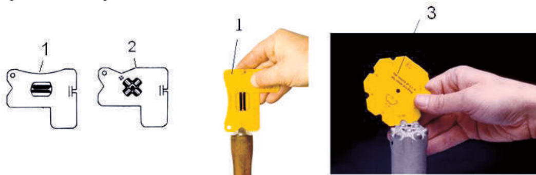
Сл.71. Шаблони за контрола на изостреноста на круните: 1-шаблон за круна со едно сечиво ; 2-шаблон за круна со две сечива, 3-шаблон за круна со брадавици.
