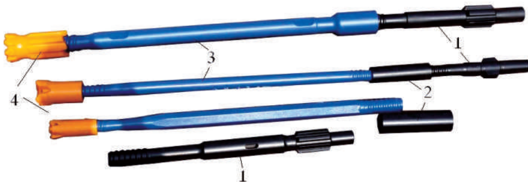
Сл.68. Длета за столбни дупчачки чекани : 1-краток дел со всадник; 2-цилиндрична спојка; 3-дупчачка шипка; 4-заменлива круна.
